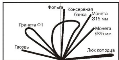
1. Годографы небольших и средних объектов из железа располагаются в левой половине экрана. Т.е. имеют наклон влево, относительно центра горизонтальной оси по нижней границе экрана.
