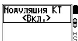
Данная опция позволяет расширить возможности звуковой индикации, при этом сделав КТ более информативным в зоне малых сигналов.
