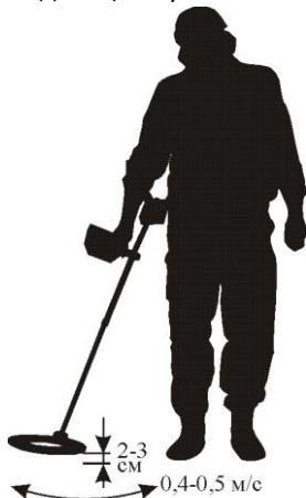
Также старайтесь не делать резких перемещений датчика по горизонтали. Оптимальная скорость сканирования 40-50 см/с. Каждый следующий проход датчика должен перекрывать предыдущий хотябы наполовину.
