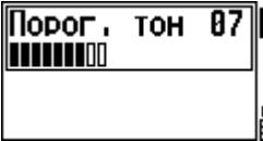
Данная опция позволяет проводить регулировку чувствительности (глубины обнаружения) порогового тона Вашего прибора. Пороговый тон - это сигнал канала обнаружения, дающий Вам информацию о том, что прибор обнаружил металлический предмет. С момента
