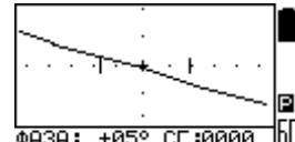
можно подкорректировать баланс в нужную сторону, покачивая катушкой вертикально над грунтом (поднимая на 20-30см / опуская на 3-5см ), следя за тем, чтобы вектор грунта в итоге «ложился», совпадая с горизонтальной осью шкалы, а гудение прибора при подъёме или опускании датчика полностью исчезло.
