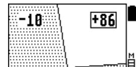
Диапазон дискриминации Вашего прибора задаётся разрешённой шириной сектора поиска (сектор по VDI, между левой и правой границами дискриминатора). При включении режима дискриминации Ваш прибор будет реагировать только на объекты, VDI и годограф которых находятся в этом разрешённом к приёму секторе.
