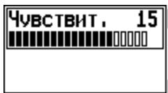
Данная опция позволяет проводить регулировку чувствительности Вашего прибора. Вы можете изменить её значение от 0 до 21. Помните, с увеличением чувствительности прибора не только возрастает глубина поиска, но и повышается возможность появления помех
