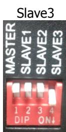
В режиме "Master" блок является основным и работает во всех режимах без ограничений. В режиме "Slave" работает как расширитель зон (макс 32) с ограниченными возможностями. В этом случае блок поддерживает работу только удаленных пультов T-8000BW, входов Fire Alarm, Alert, Evac и EMC in.
