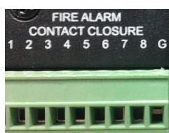
Сухие контакты пожарной сигнализации 1-8 зоны соответственно. При подаче сухого контакта на G + 1-8 срабатывает встроенная сигнализация, которая звучит в зоне соответствующей сухому контакту. Имеет приоритет перед всеми входами кроме EMC IN и MIC1 после нажатия кнопки EMERGENCY на передней панели. При исчезновении сигналов с EMC IN и MIC1 сигнализация продолжает работать. Так же после снятия сухого контакта матрица возвращается в исходное положение.
