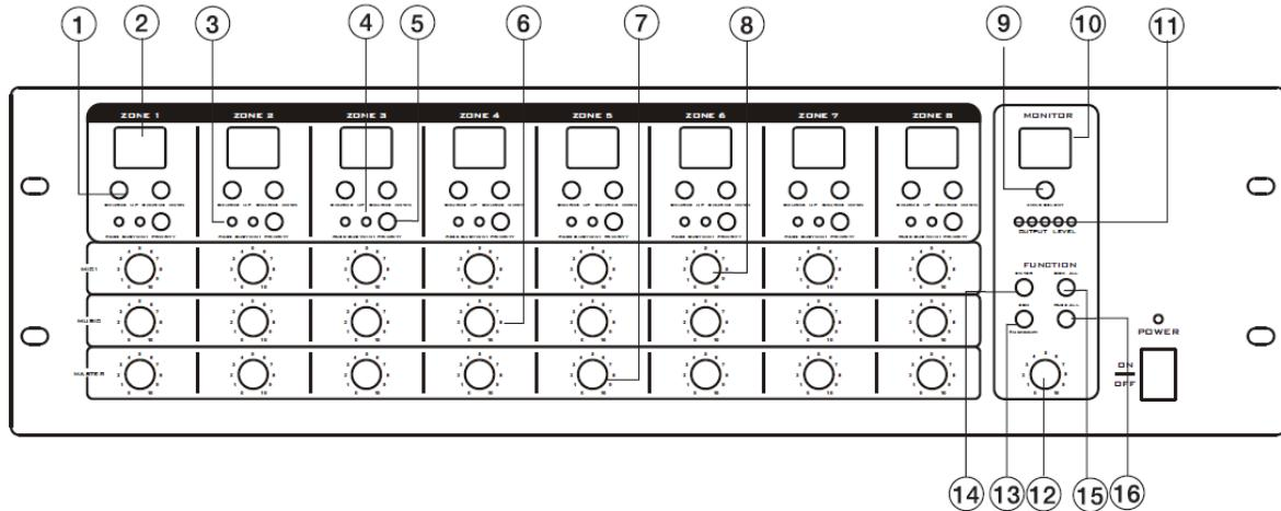
① Source Up, Source Down – Кнопки выбора источника звукового сигнала.
